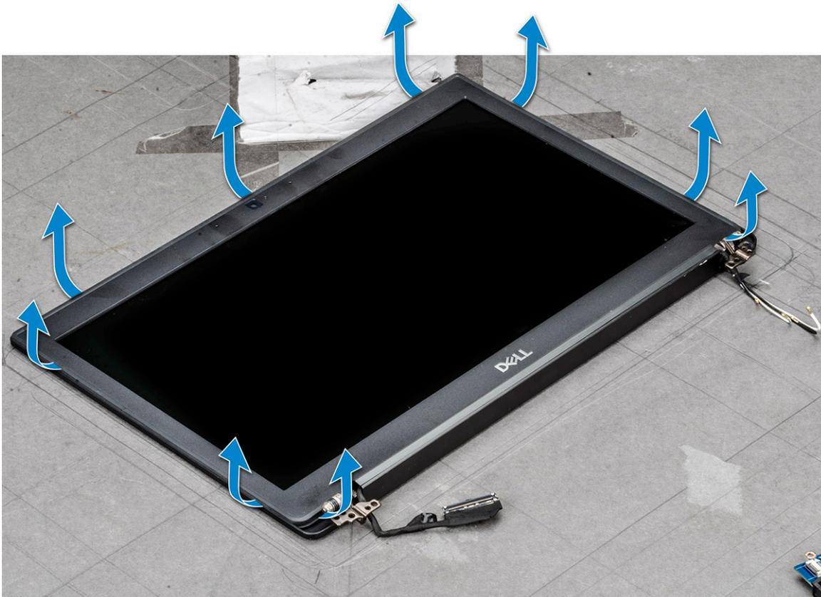
**⚠ VORSICHT:** Die LCD-Blende ist mit Klebstoff mit dem LCD-Display versiegelt. Hebeln Sie die Kanten auf und arbeiten Sie sich am Rand entlang, um die Blende zu lösen. Durch die Versiegelung können die Schichten getrennt oder das Glas zerbrochen werden, wenn Sie versuchen, die beiden Elemente gewaltsam zu trennen.
