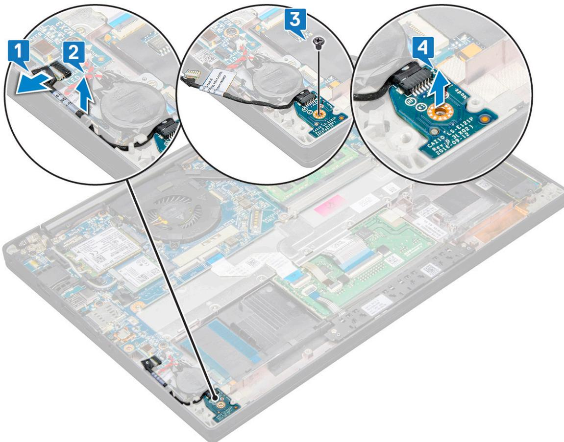
**ANMERKUNG:** Führen Sie das Kabel der LED-Tochterplatine beim erneuten Einbau des Kabels auf dem Latitude 7290 richtig durch die Kabelführungskanäle entlang der linken Seite der Halterung des Fingerabdrucklesers.
