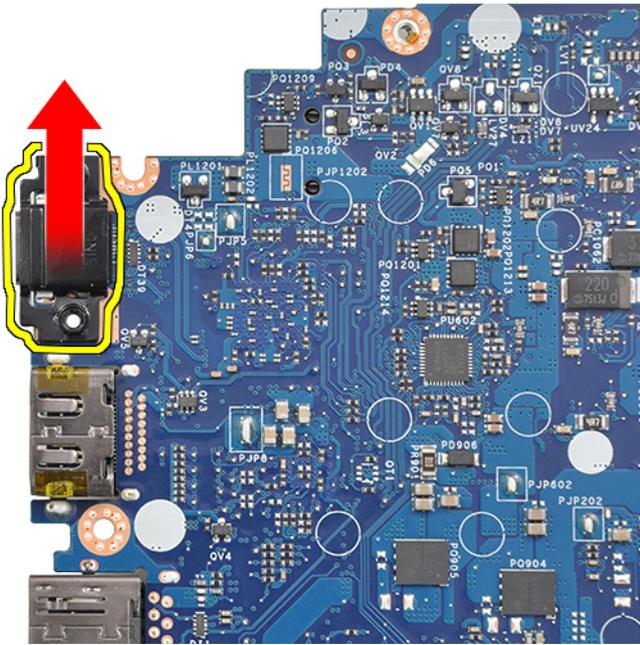
**ANMERKUNG:** Beim Entfernen oder erneuten Einbauen der USB-Typ-C-Halterung von/an der Systemplatine, müssen Techniker die Systemplatine auf eine ESD-Matte legen, um Beschädigungen zu vermeiden.
