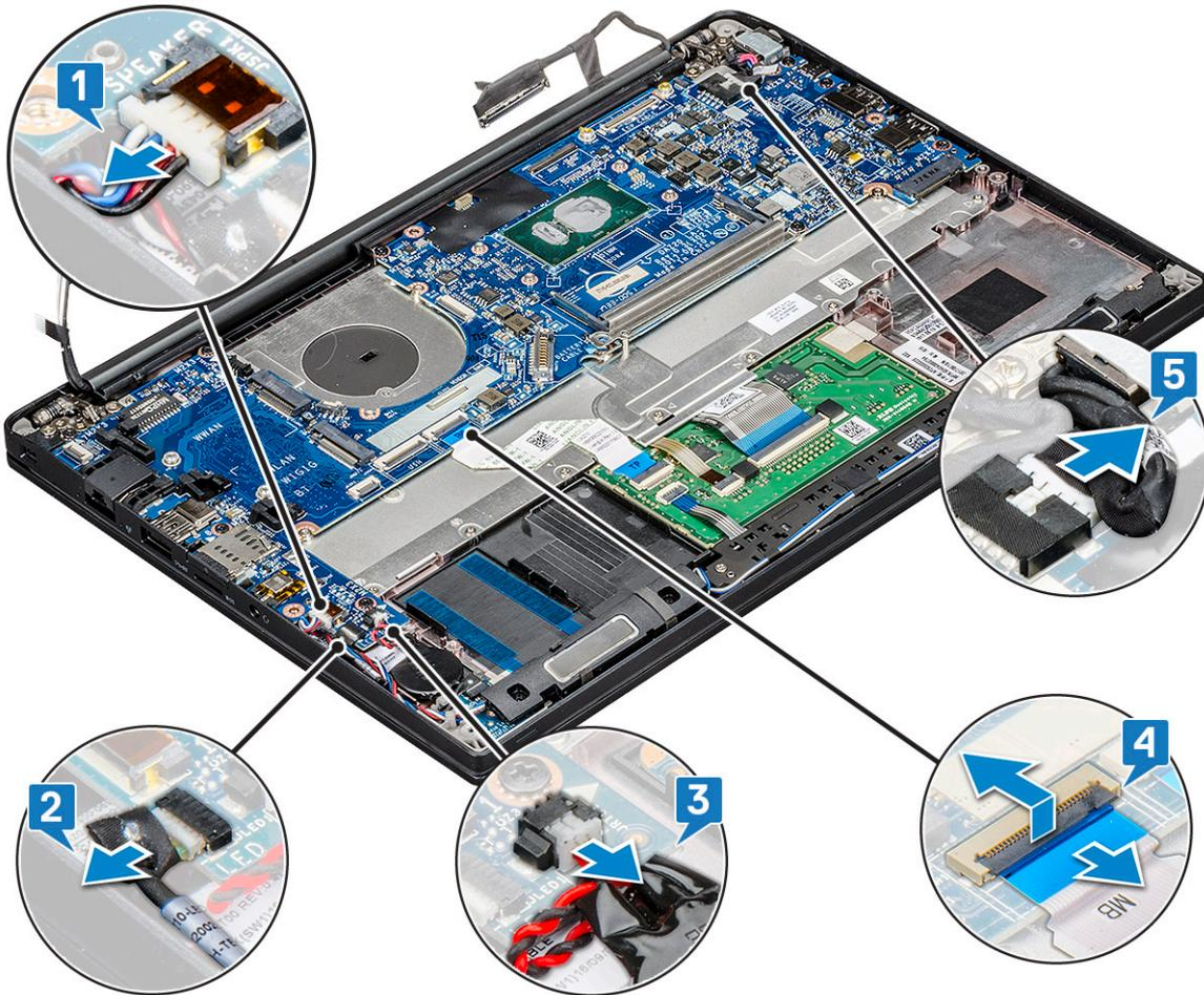
5. So entfernen Sie die Speichermodulhalterung:
