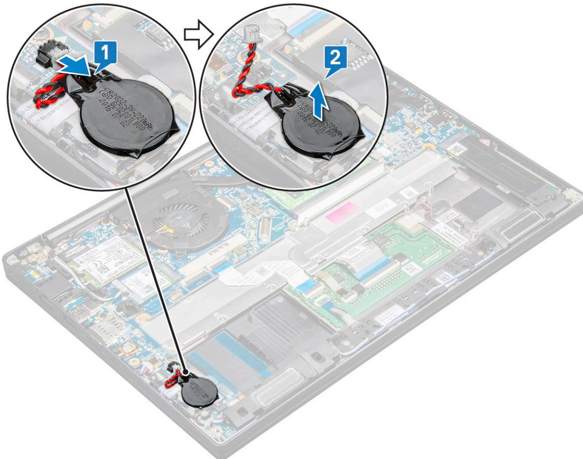
**ANMERKUNG:** Beim Entfernen oder Ersetzen der RTC-Batterie oder der Systemplatine für Latitude 7290 muss die RTC-Batterie mit ihrem Klebeband auf der Halterung des Fingerabdrucklesers platziert und befestigt werden.
