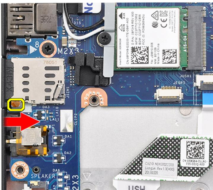
2. Ziehen Sie das Dummy-SIM-Kartenfach aus dem System heraus.
