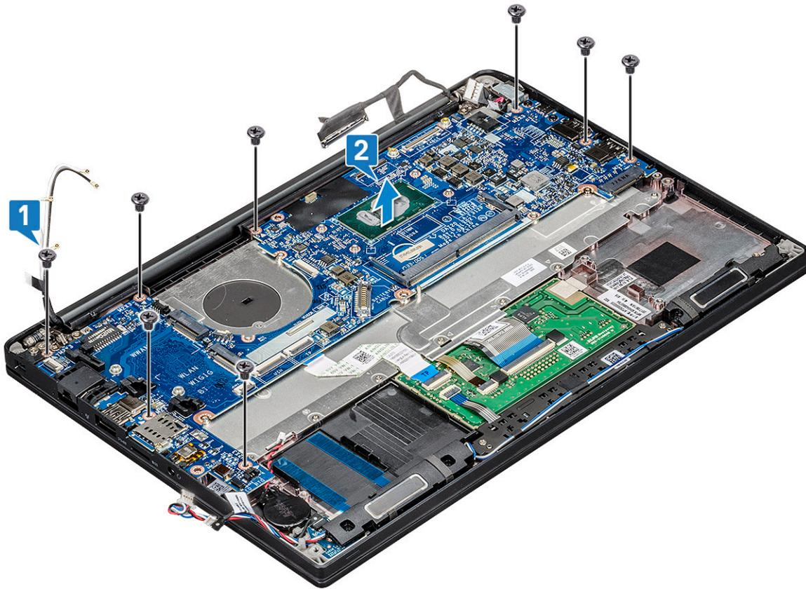
7. Entfernen Sie die M2,0x3,0-Schraube, mit der die USB-Typ-C-Halterung befestigt ist.
