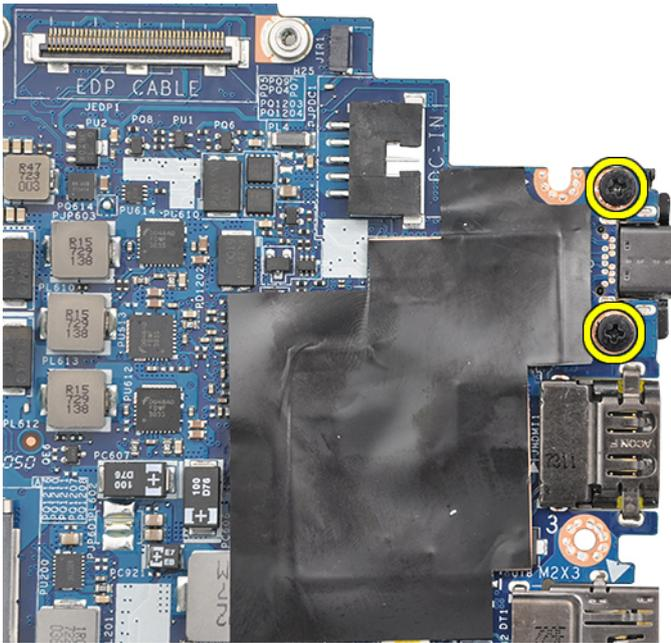
8. Drehen Sie die Systemplatine um, ziehen Sie das Klebeband ab, mit dem die Halterung befestigt ist, und entfernen Sie den USB Typ-C-Port unterhalb der Systemplatine.
