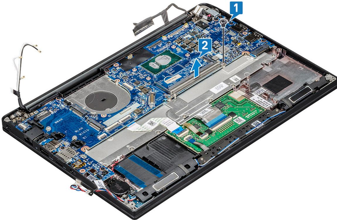
6. So entfernen Sie die Systemplatine:
