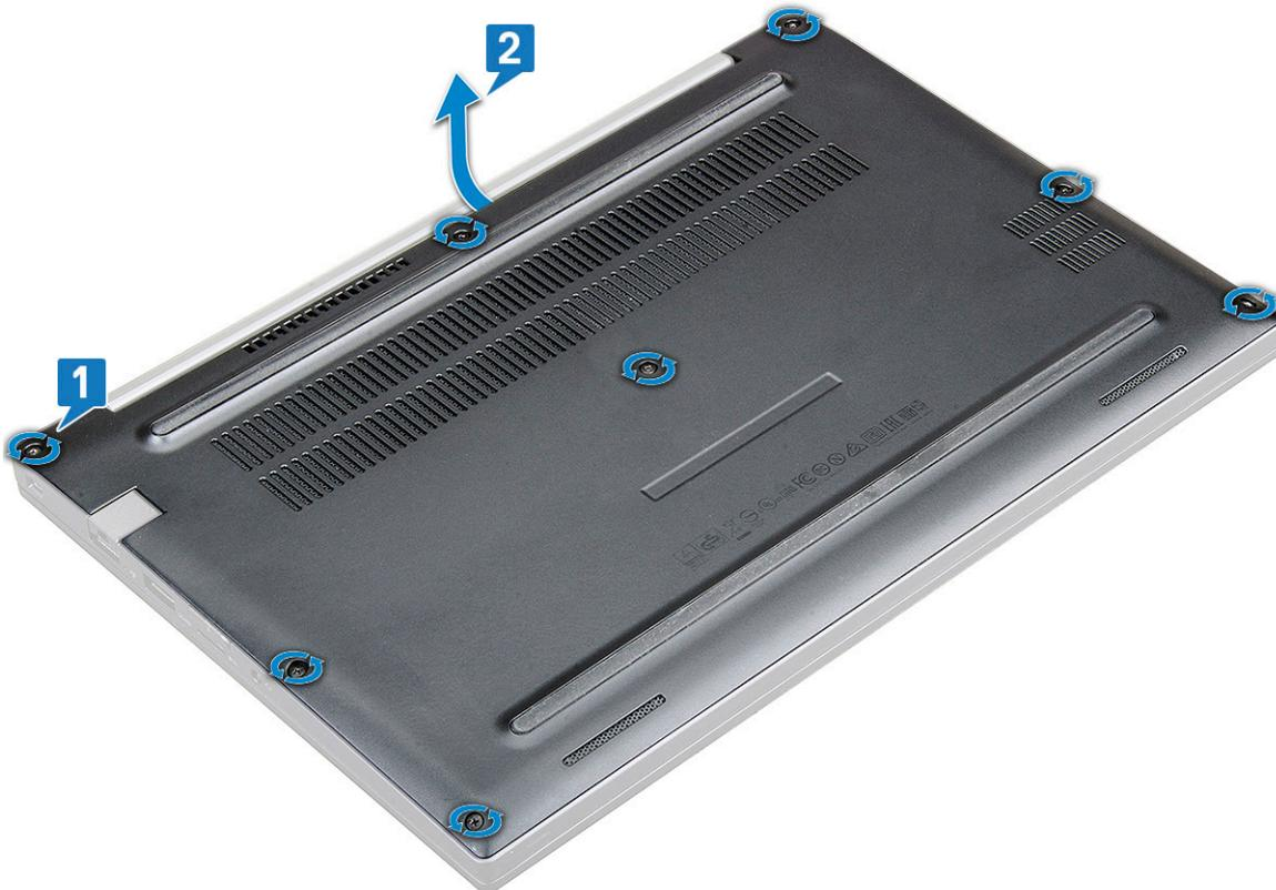
3. Heben Sie die Bodenabdeckung vom System.
