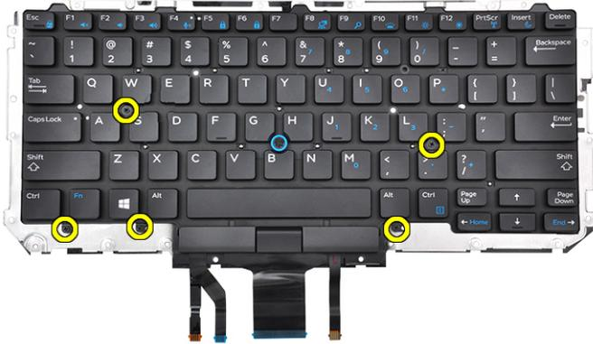
4. Heben Sie die Tastatur aus dem Tastatur-Auflagefach.
